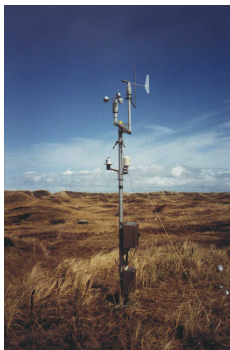
Abb. 3.2: Niederschlagsgeber (links) und Geräteträger mit Sensoren (rechts) von der Firma Thies aus
